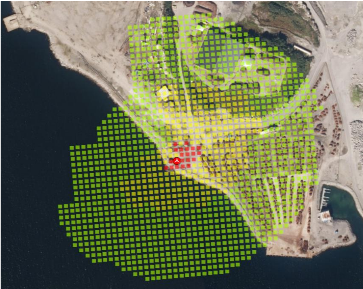
Figur 7. Illustrasjon over raud, gul og grøn iskastzone (Kjelde: Meventus). Den gule og grønne iskastsona ligg delvis innanfor planområdet. I gul sone kan det etablerast industri med tilhøyrande kontor, men det skal vere dokumentert at det er teke omsyn til fare for iskast.
